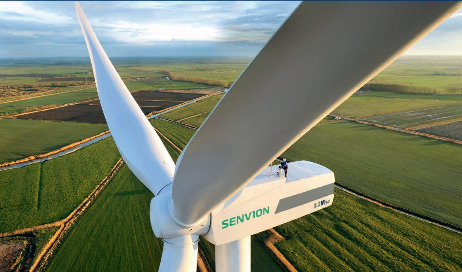
Die CEPP setzt auf die Senvion-Anlage des Typs 3,2MW114.
